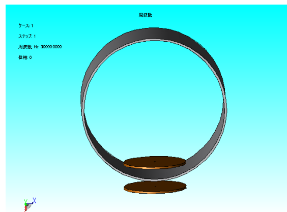
図3 一次・二次ともに円形空心コイルで作成した空心変圧器のシミュレーションモデル
