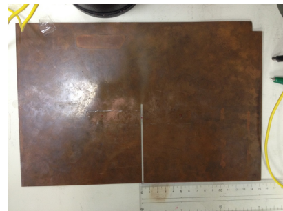
図 5 厚さ 1 mm、欠損幅 2 mm の被検査対象銅板
