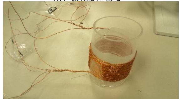
図7 試作空心変圧器の外観
