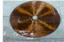
図 8 平面ドーナツ状励磁コイル
