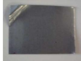
図 9(b) 歪み欠損を有する珪素鋼板
