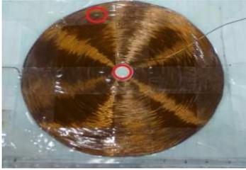
図 13 平面ドーナツ状励磁コイル
