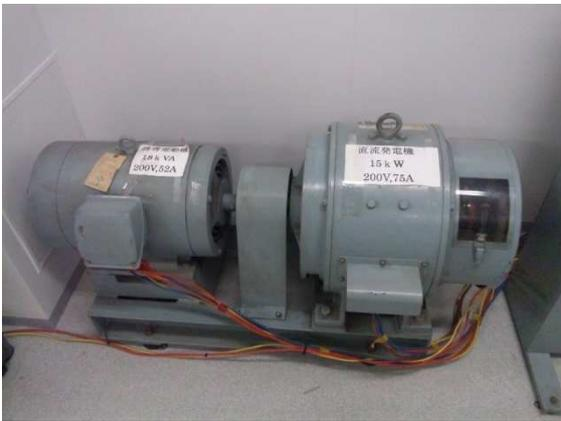
図5 誘導電動機及び直流発電機
