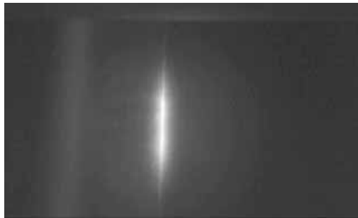
図4 接合部分を含む鉄板の赤外線画像
