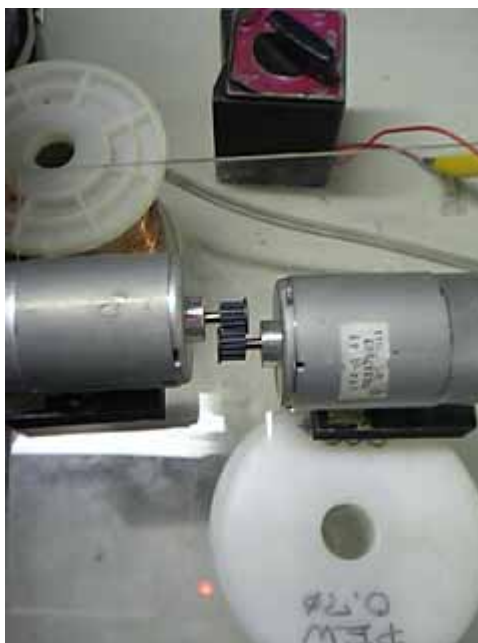
図 2 3 歯車を用いたモーター直結
